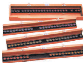
Farnsworth Farbtest 100 HUE bestehend aus: – 4 Kästen mit je einem fest installierten Farbknopf – 85 bewegliche Farbkнопfe – 1 Block zu 100 Diagrammen – 1 Gebrauchsanweisung
