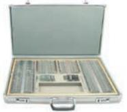
**Der Messgläserkasten 500** mit CE-Kennzeichnung besteht aus 266 Teilen und Bi-Konvex-Linsen mit Metallringen. Passend zu allen Standard-Messbrillen.
